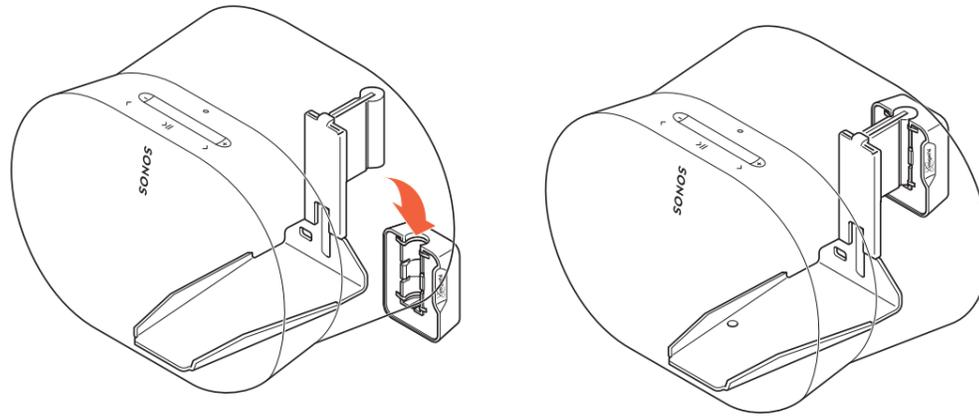
1. Heben Sie den Lautsprecher an und setzen Sie das **Neigungsmodul** (A) in die **Wandhalterung** (D).
