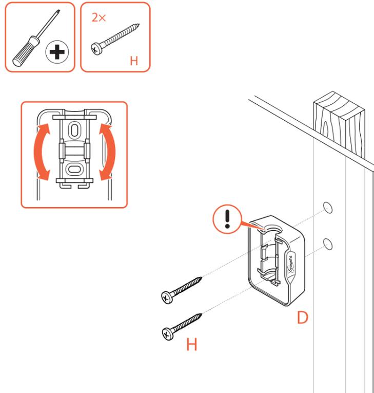
6. Befestigen Sie die **Wandhalterung** ④ mit den **Schrauben** ⑤ an der Wand. Verwenden Sie die integrierte Wasserwaage, um die **Wandhalterung** ④ zu neigen, bis sie waagrecht ist.
