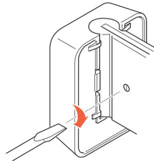
3. Befestigen Sie den Lautsprecher, indem Sie die Stellschraube an der Seite des **Neigungsmoduls** anziehen ①.
