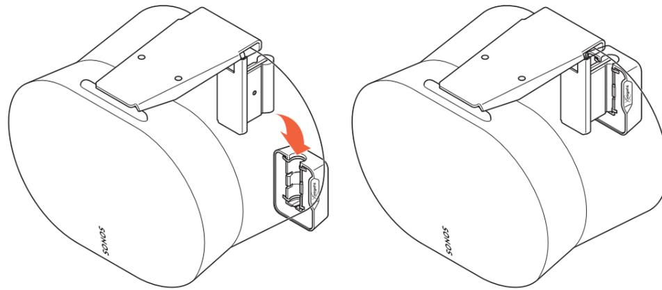
1. Heben Sie den Lautsprecher an und setzen Sie das **Neigungsmodul** ① in die **Wandhalterung** ②.
