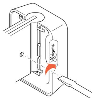
3. Befestigen Sie den Lautsprecher, indem Sie die Stellschraube an der Seite des **Neigungsmoduls** anziehen (A).
