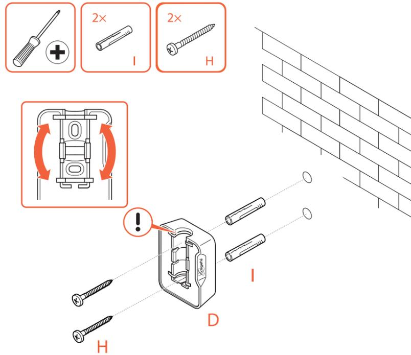
5. Befestigen Sie die **Wandhalterung** ④ mit den **Schrauben** ④ und den **Dübeln** ① an der Wand. Verwenden Sie die integrierte Wasserwaage, um die **Wandhalterung** ④ zu neigen, bis sie waagrecht ist.
