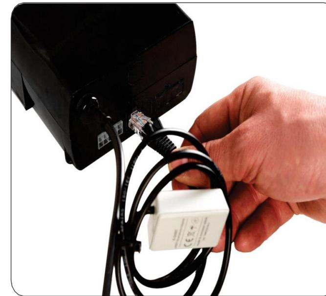
Stecken Sie den Stecker des MSM07 in die dafür vorgesehene RJ-45 Dose des Steuergerätes einer MonLines Halterung/Lift.
