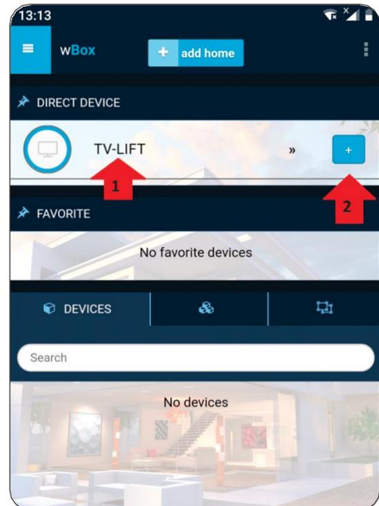
Sie können jetzt den MonLines TV Lift sofort ansteuern, indem Sie erst auf das «+» Symbol (mit 2 gekennzeichnet) klicken und anschließend auf «TV-Lift» klicken (mit 2 gekennzeichnet)
