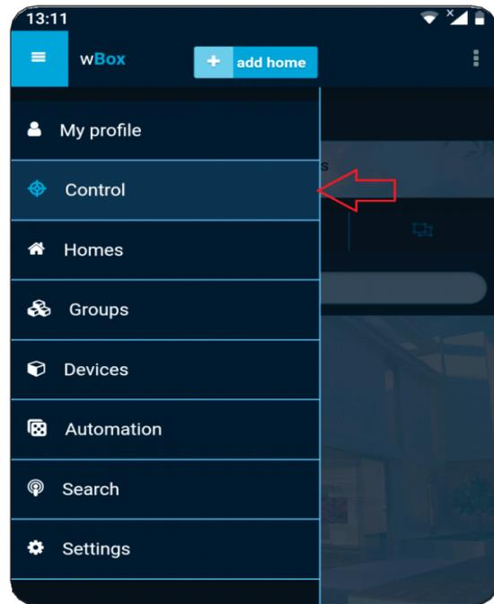
Öffnen Sie die wBox App. Wählen Sie oben links die 3 Balken an. Ein DropDown Menü öffnen sich. Wählen Sie dort «Steuerung» aus.
