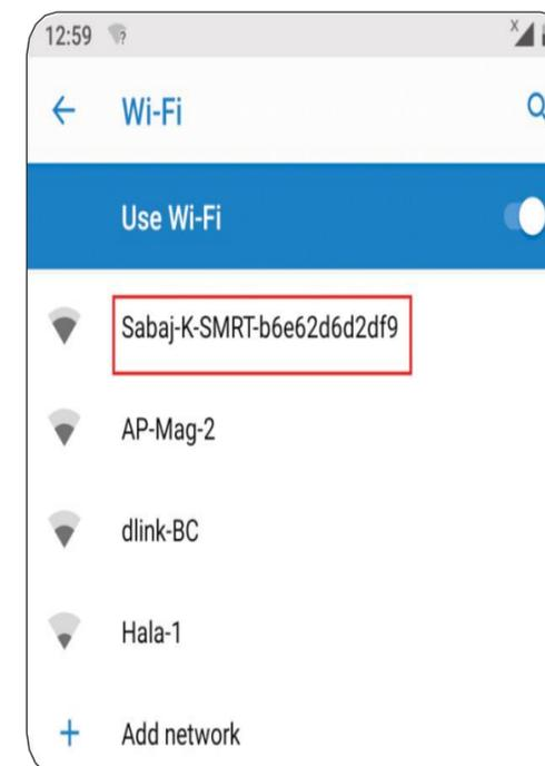
Verbinden Sie Ihr Smartphone mit dem WiFi Netz. Hier gehen Sie genauso vor, als würden Sie eine WLAN Verbindung herstellen. Bspw. bei einem Samsung S8 unter Einstellungen -> Verbindungen -> WLAN. Dort werden Ihnen sämtliche verfügbaren Netzwerke angezeigt. Wählen Sie dort das Netzwerk «Sabaj-KSMRT-xxxxx» aus und verbinden Sie Ihr Smartphone damit. Die xxxx sind hierbei zufällige Zahlen/Buchstaben.
