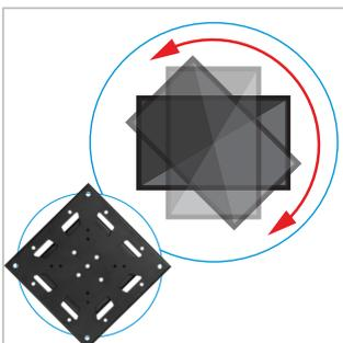
Montierte Bildschirme können vom Querformat ins Hochformat gedreht werden (oder umgekehrt)
